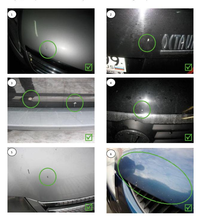
Повреждения, **НЕ принимаемые** Банком как нормальный износ. Многочисленные (две и более) вмятины на одной детали (рис. 1-2). Царапины, достигающие металлической основы и/или длиной более 25 мм (рис.3-6).
