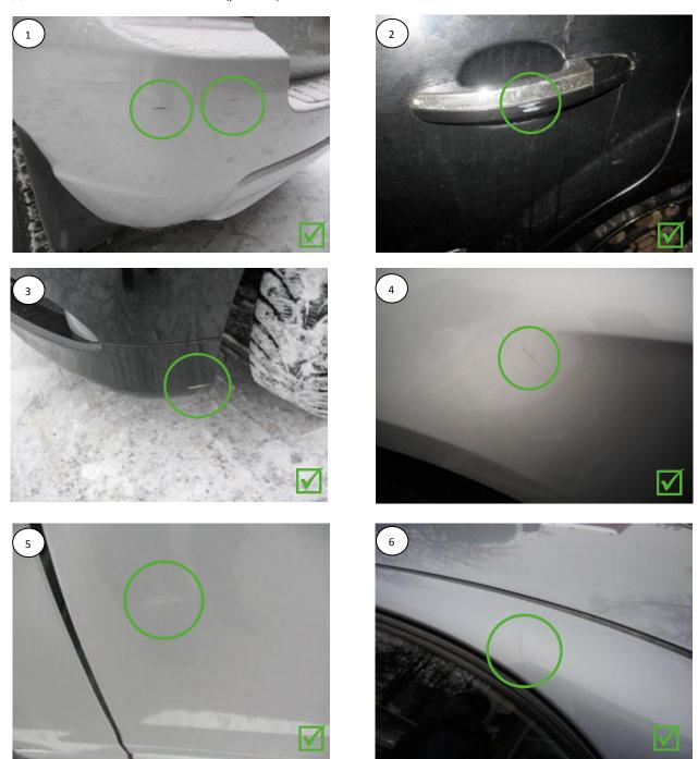
Повреждения, **принимаемые** Банком как нормальный износ. Вмятины до 10 мм глубиной, при условии не больше одной вмятины на каждой детали (рис. 1-4).
