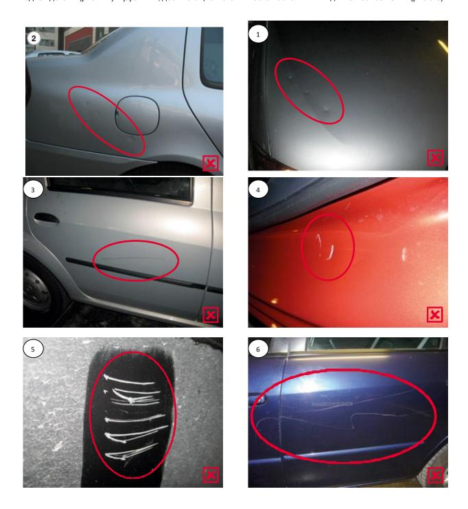
Повреждения, **НЕ принимаемые** Банком как нормальный износ. Отсутствие любых эмблем и идентификационных знаков (рис. 1-2). Наличие стикеров / наклеек на кузове автомобиля. Повреждения лакокрасочного покрытия в результате использования рекламных стикеров / наклеек на кузове автомобиля. Деформации на кузове автомобиля. Кроме единичных вмятин глубиной до 10 мм. (рис. 3-6).
